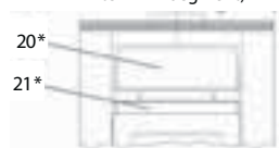
Ausführung II zweiteilige Hitzeschutzplatte (Pos. 20 + 21; hinter WHF-Segment)
